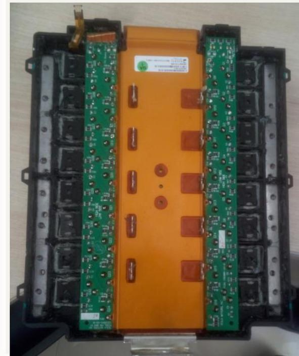
Tesla 分立IGBT并联电机控制器
