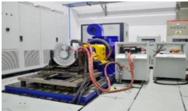
电动航空电驱系统测试台架
