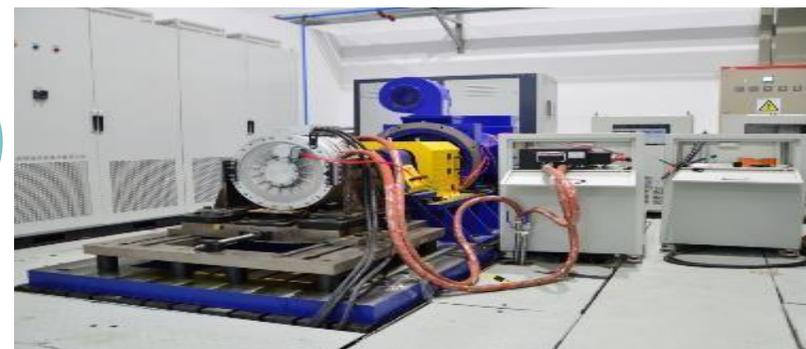
台架具备全功率段/全类型电机EMC、环境、安规、NVH、理化分析等测试能力，检测中心通过CNAS国家认证
